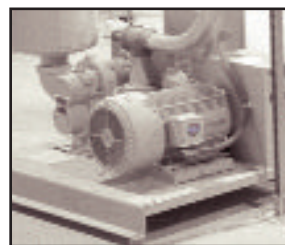
Ключевое звено системы – мотор/воздуходувка с воздушным клапаном. Воздуходувка защищена двух-стадийным фильтрованием.
