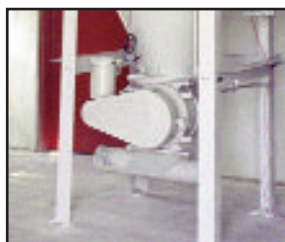
Роторный питатель разделяет вакуумную и нагнетательную сторону системы
